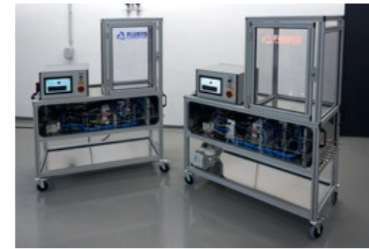
Automatisierte Leckageprüfeinheit für H 2 Anwendungen
