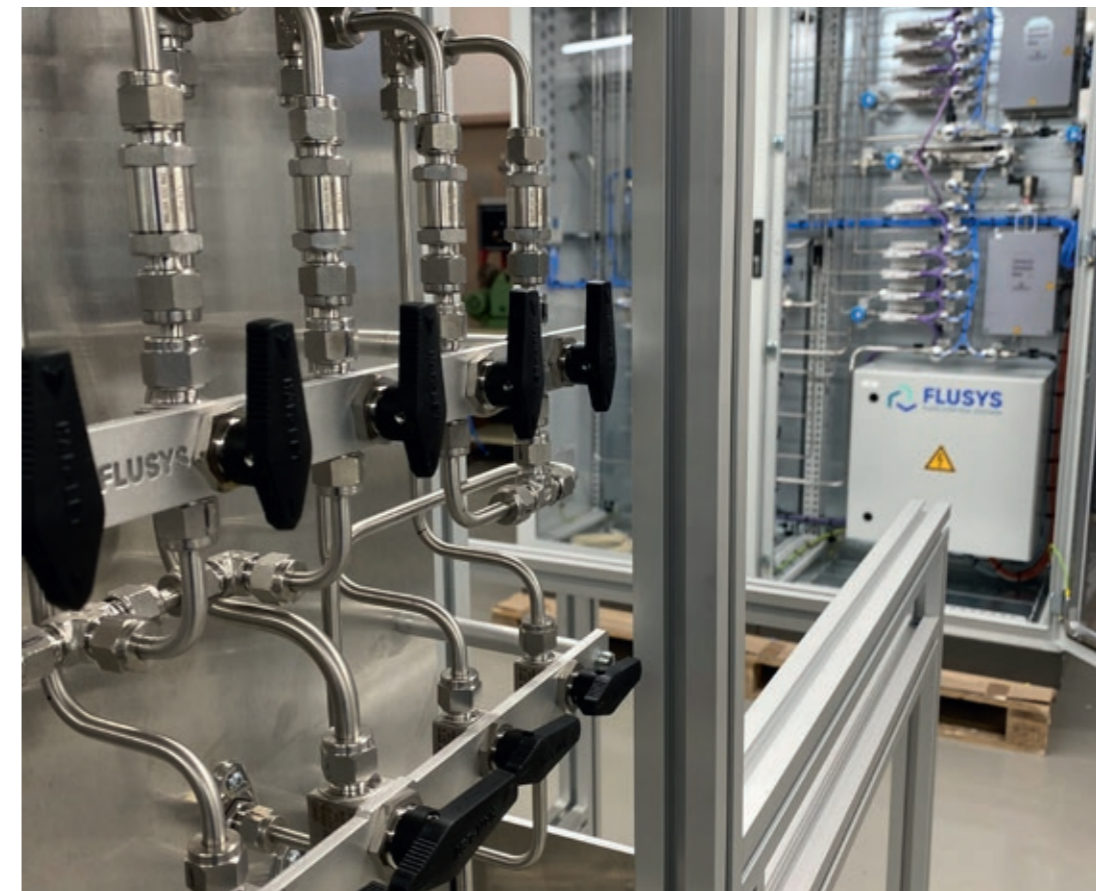
Fluid Kabinett – orbital verschweisst oder mit Klemmring verrohrt
