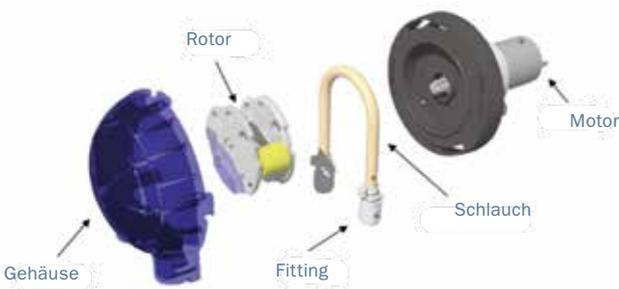
Das Fördervolumen ist abhängig von der Drehzahl, Anzahl der Rollen und Durchmesser des Förderschlauchs. Die Elastizität des Schlauches reicht aus, um den nötigen Ansaugunterdruck zu erzeugen. Der maximale Druck beträgt in der Regel 1 bar.
