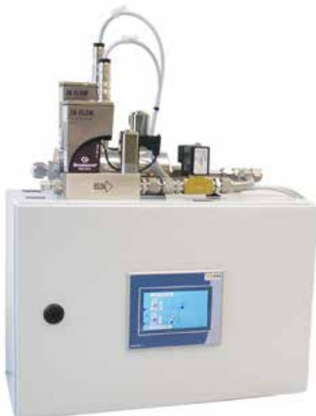
Zweikanal-Gasmischer Ar/He und H 2 /CH 4 /C 3 H 8 etc.
