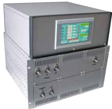
Gasmischer zur Prüfgaserzeugung (Laborausführung)
