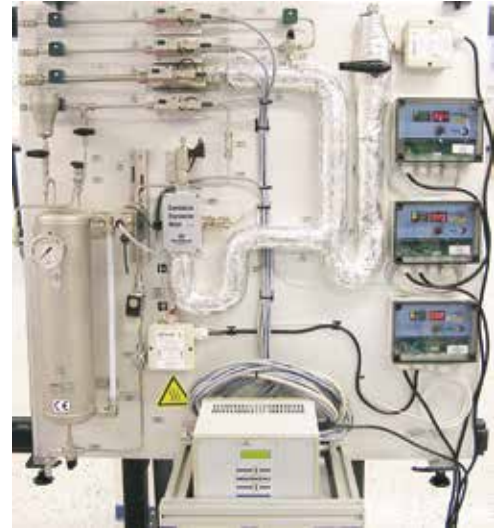
Teilautomatisiertes Mischsystem inklusiv Flüssigkeitsbevorratung und Nachtemperierung
