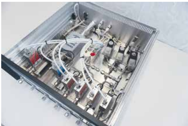
Gasmischsystem mit integrierter Befeuchtungs-Dosiereinheit
